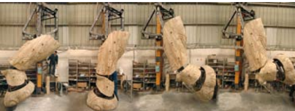
Essais hydrauliques de mouvement d'une patte du Grand Éléphant
